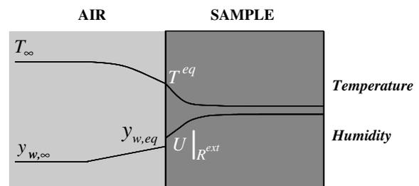
Fig. 3. Air–dough interface scheme.
